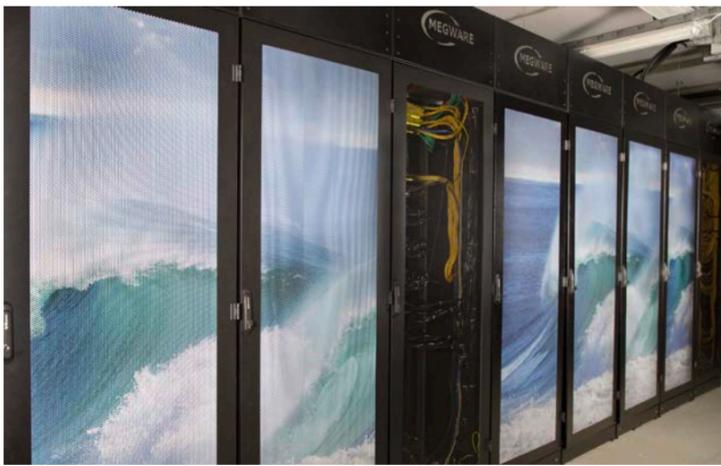
„CoolMUC-3“ liefert mittels Wasserkühlung Warmwasser, das für eine gekoppelte Adsorptionskältemaschine verwendet werden kann. (Abb. Schäfer IT Systems).
